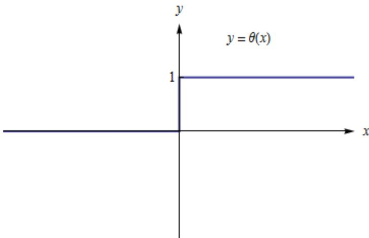
Покажем, что дельта-функция является обобщённой производной ступенчатой функции Хевисайда (тэта-функции):
