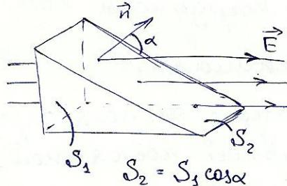
$$\Phi = \vec{E} \cdot \vec{n} S = E S \cos \alpha = E_n S - \text{поток вектора напряженности эл. поля.}$$
