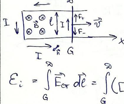
Сила Лоренца:  $\vec{F} = q[\vec{v}, \vec{B}]$  — сопротивление силы, содействующей току.
