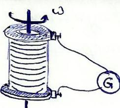
Если находящуюся в быстром вращении катушку резко затормозить, то свободные электроны в проволоке продолжают движение по инерции, в результате чего гальванометр демонстрирует импульс тока. (37)
