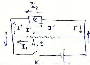
$$\text{ноне установление тока: } I_1 = \frac{E}{x}, I_2 = \frac{E}{R}$$
