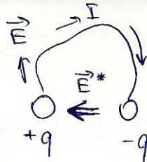
Для поддержания эл. тока в замкнутой цепи (15) необходимо устр-во (источник тока), совершающее посредством смены знака сил перемещение зарядов против действия эл. сил.
