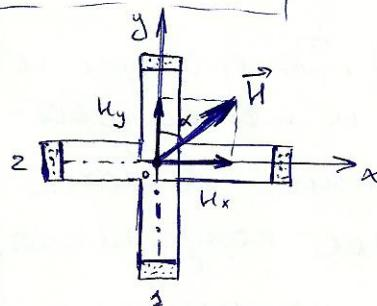
1 и 2 - катушки, повернутые на  $90^\circ$  друг относительно друга. Если ток  $i_1$  меняется по з-му  $i_1 = i_0 \sin \omega t$ , то ток  $i_2$  будет:  $i_2 = i_0 \sin(\omega t - 90^\circ)$ . Катушка 1 создаёт переменное магн. поле  $H_x = H_0 \sin \omega t$ .
