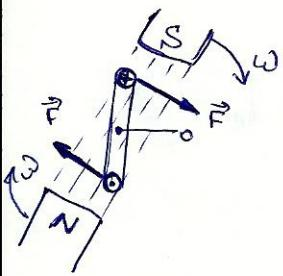
Вращающееся магн. поле можно получить не используя переменных токов. Рассмотрим спарана получение вращающегося поля при помощи двухфазного тока:
