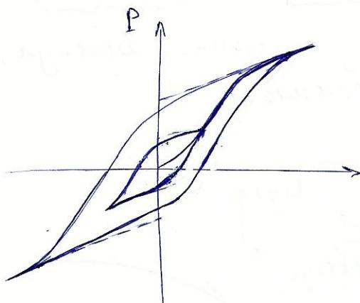
При повышении темп-ра выше некоторого значения  $T_K$ , характерного для каждого сингенита, его  $\epsilon/\chi$  св-ва исчезают и он превращается в обычный пьезородник. Точка фазового перехода из состояния  $\epsilon/\chi$ -ка в состояние пьезородника наз. точкой Кюри, а соответствующая ей температура  $T_K$  — температура Кюри.
