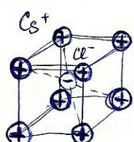
В кристаллических в-вах возможно смещение положительной и отрицательной точных подрешеток относительно друг друга под действием внешнего эл. поля. Поляризация наз. ионной поляризацией.
