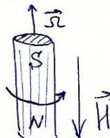
Две магнитомехан. и механомагн. явления:  $\Gamma < 0$ . Следует, что они обусловлены движением электронов.
