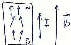
$W = -\vec{p}_m \cdot \vec{B} \Rightarrow dn = Ae^{-\frac{W}{kT}} d\Omega$ , где  $d\Omega = \sin\theta d\theta d\phi$ .
