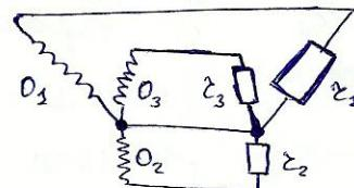
соединение обмоток "треугольником":
