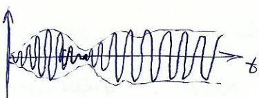
Процесс установления вынужденных колебаний при резонансе:
