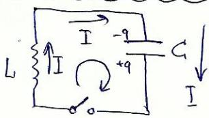
$$L \frac{d^2q}{dt^2} + \frac{q}{C} = 0 \Rightarrow \ddot{q} + \omega_0^2 q = 0, \text{ где } \omega_0 = \frac{1}{\sqrt{LC}}.$$
