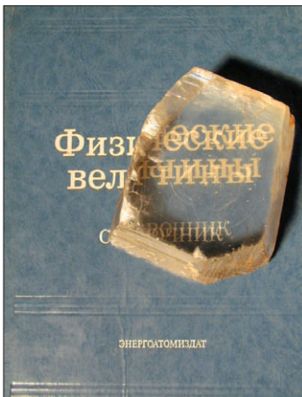
Рис. 19.1. Двойное лучепреломление в кристалле кальцита
