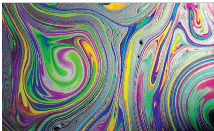
Рис. 9.1. Линии равной толщины на поверхности масляной пленки
