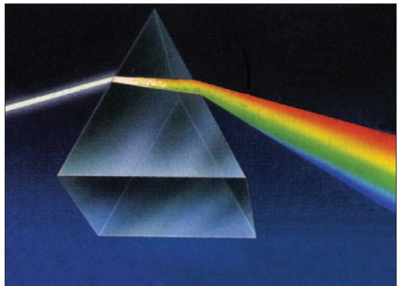
Рис. 17.1. Разложение белого света на цвета призмой
