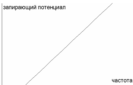
Рис. 1.6. Зависимость запирающего потенциала от частоты излучения.
