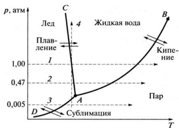
Рис. 4.5. Диаграмма состояния воды (схема)
