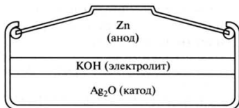
Рис. 7.7. Схема серебряно-цинкового элемента
