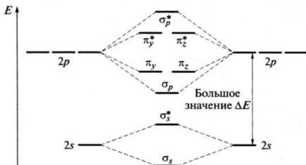
Рис. 9.16. Энергетическая диаграмма молекулярных орбиталей гомоядерных двух-атомных молекул второго периода при большой разности энергий 2s - и 2p -подуровней взаимодействующих атомов (молекулы O_2 и F_2 )
