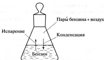
Рис. 4.1. Равновесные процессы в колбе с бензином
