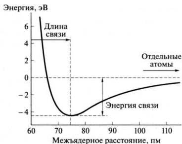
Рис. 9.2. Зависимость энергии молекулы \text{H}_2 от межъядерного расстояния
