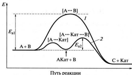
Рис. 3.9. Энергетический профиль реакции, протекающей в отсутствие (1) и в присутствии (2) катализатора
