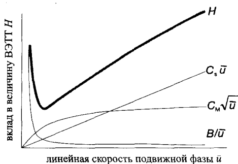
Рис. 5.5. Вклад членов, характеризующих диффузию B/\bar{u} и массоперенос C_M \sqrt{\bar{u}} , C_S \bar{u} , в величину ВЭТТ H .
