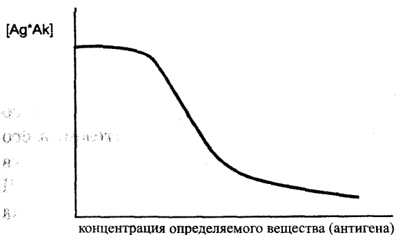
Рис. 8.22. Градуировочная зависимость для радиоиммунного метода анализа. Индикаторное вещество — меченый комплекс Ag^*Ak .
