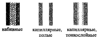
Рис. 5.18. Типы колонок для газоадсорбционной хроматографии.
