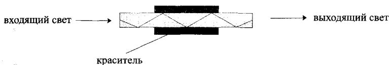
Рис. 7.25. Оптический сенсор, использующий явление поверхностных световых волн.
