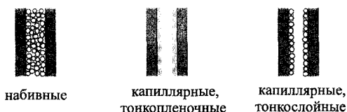
Рис. 5.12. Типы колонок для газо-жидкостной хроматографии.
