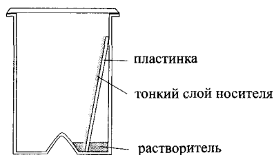
Рис. 5.38. Хроматографическая камера для тонкослойной хроматографии.
