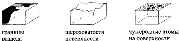
Рис. 8.7. Особенности структуры поверхности твердых тел.
