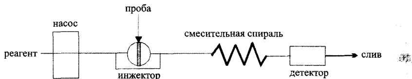
Рис. 7.6. Схема жидкостных потоков в одноканальном проточно-инжекционном анализаторе.
