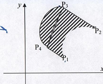
$$\begin{aligned} P_1(x(u, v), y(u, v)) \\ P_2(x(u+du, v), y(u+du, v)) \\ P_3(x(u+du, v+dv), y(u+du, v+dv)) \\ P_4(x(u, v+dv), y(u, v+dv)) \end{aligned}$$
