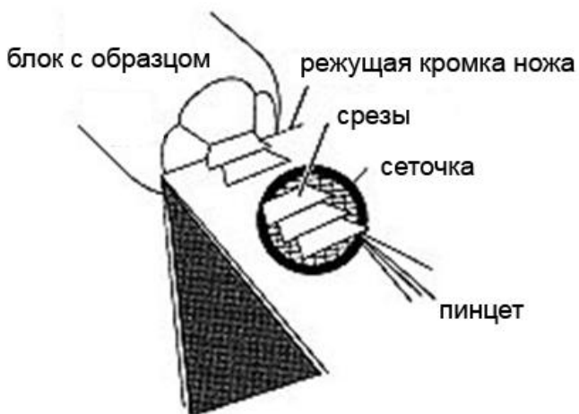
Рис. 18. Блок с образцом вставляется в ультрамикротом, стеклянный нож срезает с блока тонкие срезы, которые собираются на сеточку.
