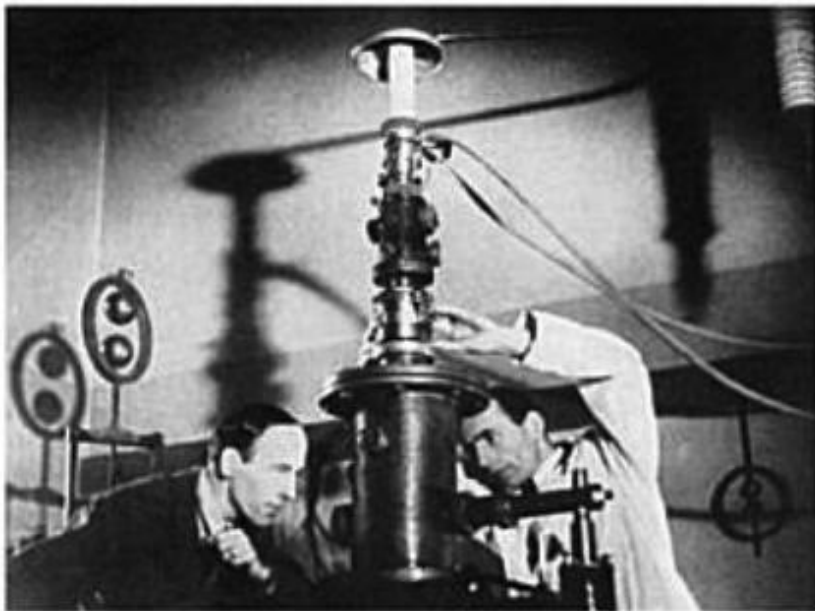
Рис. 2. Первый электронный микроскоп, созданный М. Кнолем и Е. Руской в 1931 г. в Германии.
