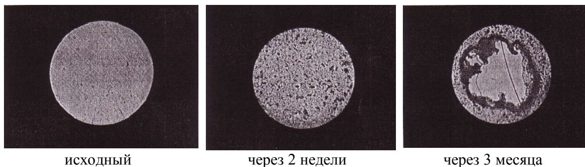
Рис. 16. Фотографии образцов СЭВА 28 – кукурузный крахмал (10%) после воздействия микромицетов Trichoderma viride Pers (при 75-кратном увеличении)
