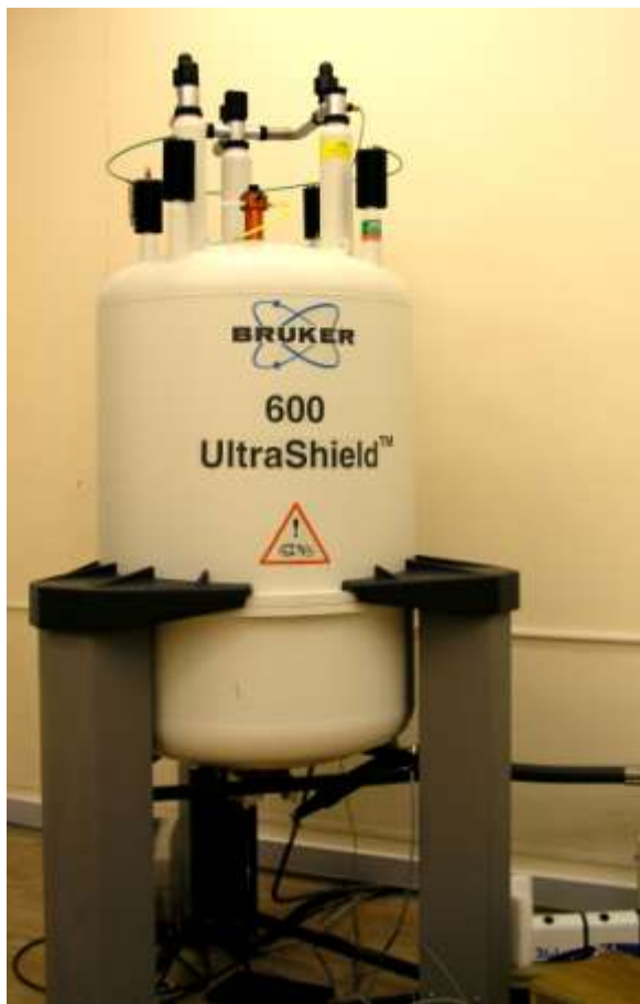
Магнит спектрометра Bruker AVANCE 600 МГц в Центре магнитной томографии и спектроскопии МГУ
