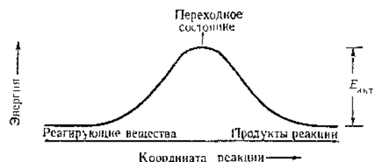
Рис. 5.8. Изменение энергии в зависимости от координаты реакции для электронного обмена, при котором реагирующие вещества и конечные продукты идентичны
