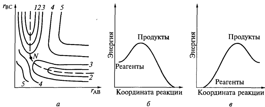
Рис. 4.6. Изменение потенциальной энергии системы в ходе химической реакции:
